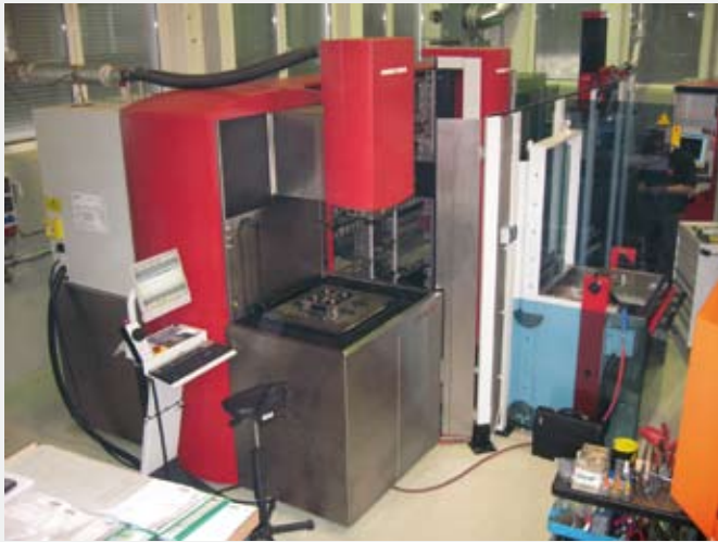
Die beiden Senkerodiermaschinen genius 700 und 850 sind über das Handlingsystem Chameleon verkettet – so funktioniert Automatisierung im Formenbau.
