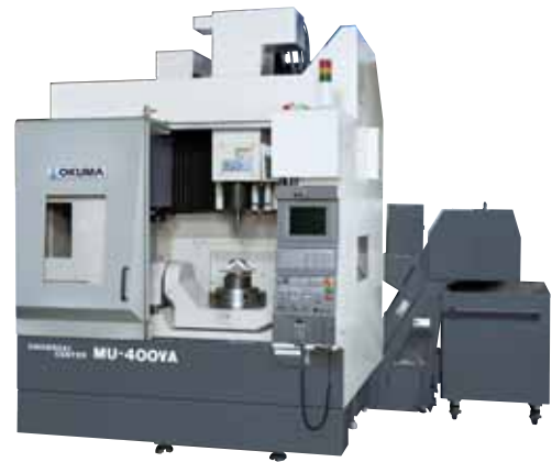
Baureihe Okuma MU: 5-Achsen BAZ MU-400VA x=762mm, y=460mm, z=460mm U=25000U/min P=22KW Werkzeugmagazinplätze=20 Steuerung=Okuma OSP-E 100 M
