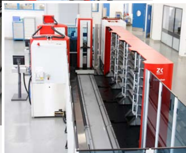
Eine homogene Gesamtanlage: Das Chameleon Handlingsystem, zwei Senkerodiermaschinen genius 700, einer als Übergabestation voll eingebundenen Transclean Reinigungsstation und eine Messmaschine von Zeiss.
