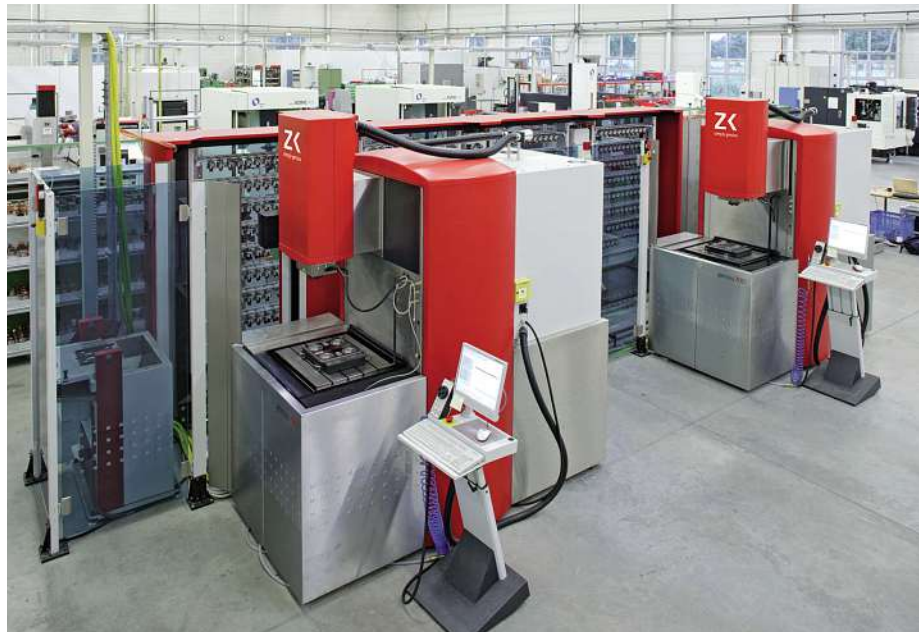
Bild 1: Mit einem Handlingsystem können mehrere Maschinen zu einer Fertigungszelle verbunden werden.
