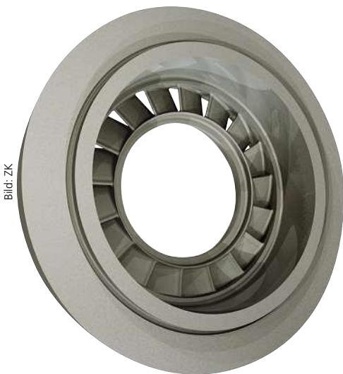
Bild 3: Endbearbeitetes Schaufelrad, simultan Sechs-Achs-Erodiert mit einer Grafitelektrode in Form einer Turbinenschaufel.
