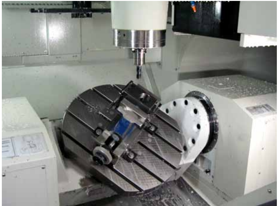
Günstiger „Modellierer“: Als High Performance BAZ für die simultane 5-Achs-Bearbeitung zeigt Quaser auf dem Emo-Messestand eine gut 12.000 kg schwere UX 600 in Portalbauweise.
