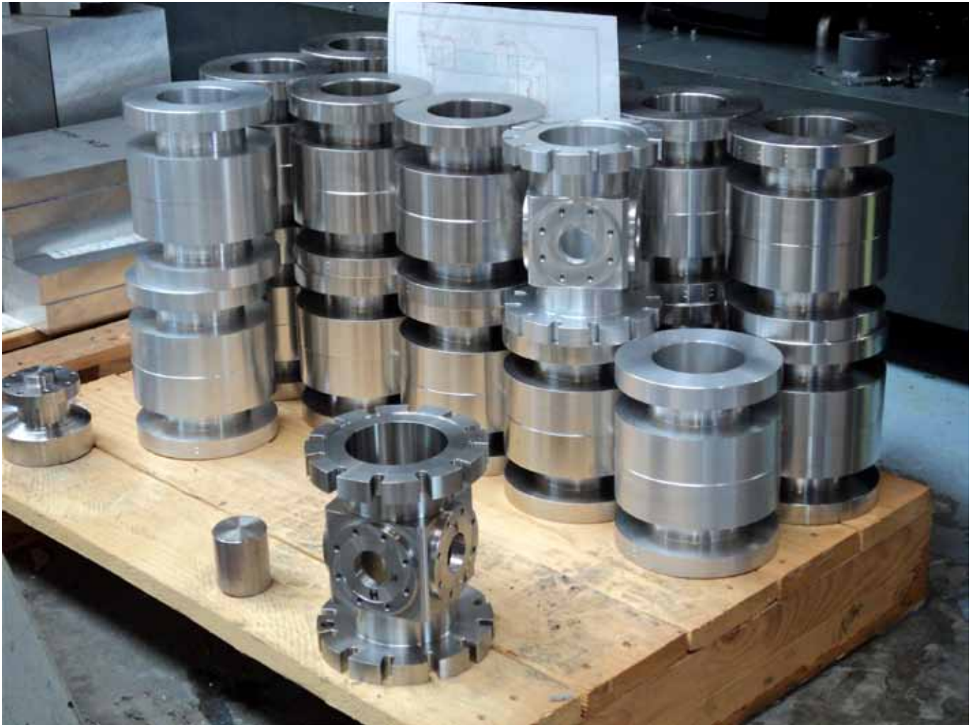
Komplexe und präzise Teile für die Vakuumtechnik fertigt die Wolf Fertigungs- und Fügetechnik GmbH in Mieming aus verschiedenen Edelstählen und Buntmetallen.
