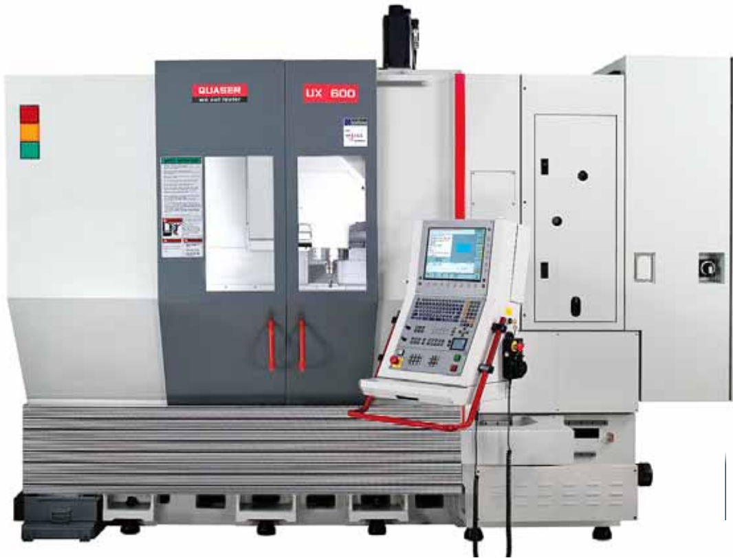
Live auf der vienna-tec – Quaser UX 600: High-Performance-BAZ für die simultane 5-Achs-Bearbeitung
