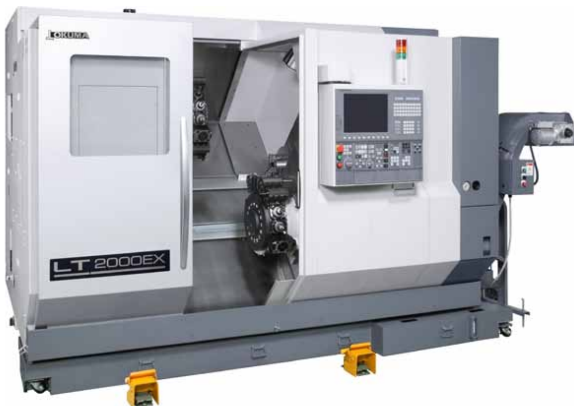
Das Drehzentrum OKUMA LT2000 EX empfiehlt sich mit zwei gegenüberliegenden Spindeln und drei 16er X-, Y-, Z-Revolvern für das effiziente Bearbeiten komplexer Futterteile mit hohen Genauigkeitsanforderungen bis Ø 200 mm, für Stangenteile bis max. Ø 65 mm und Wellen bis 700 mm Länge.
