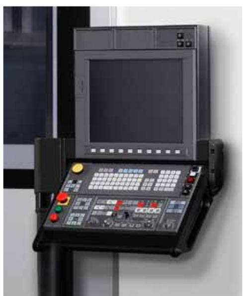
**oben** Groß, schnell, präzise: Für die 5-achsige Simultan-Bearbeitung von Freiformflächen (X/Z/Y/B/C) gibt es die MULTUS U-Modelle auch mit Vorschubsteuerung der B-Achse, absoluten OKUMA-Linearmaßstäben, Hochgenauigkeits-C-Achse, SuperNurbs mit Glättungsfunktion und Schwenken um das Werkzeugzentrum mit Werkzeuglängenkompensation. (Fotos: Okuma)
