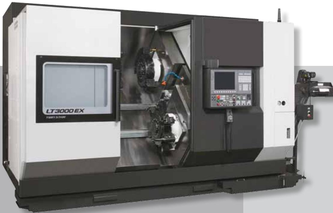
Die LT3000 EX bearbeitet Stangenmaterial von bis zu 69 mm Durchmesser und ist das jüngste Mitglied in der Familie der LT EX Serie von Drehzentren mit Doppelspindel.
