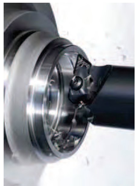
Die Tiger•tec® Silver Wendebohrerfamilie für das Drehen von Stahlwerkstoffen (ISO-P) ist nur eines der Highlights.
