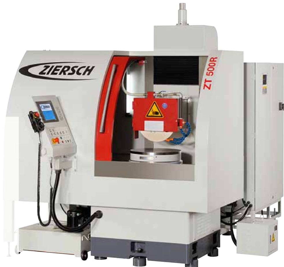
Die neue Baureihe ZT500R wird auf der AMB 2014 in Stuttgart zu sehen sein. Es handelt sich hierbei um ein Baukastensystem, das Rundtische von Ø 500 mm bis Ø 1.000 mm abdeckt.
