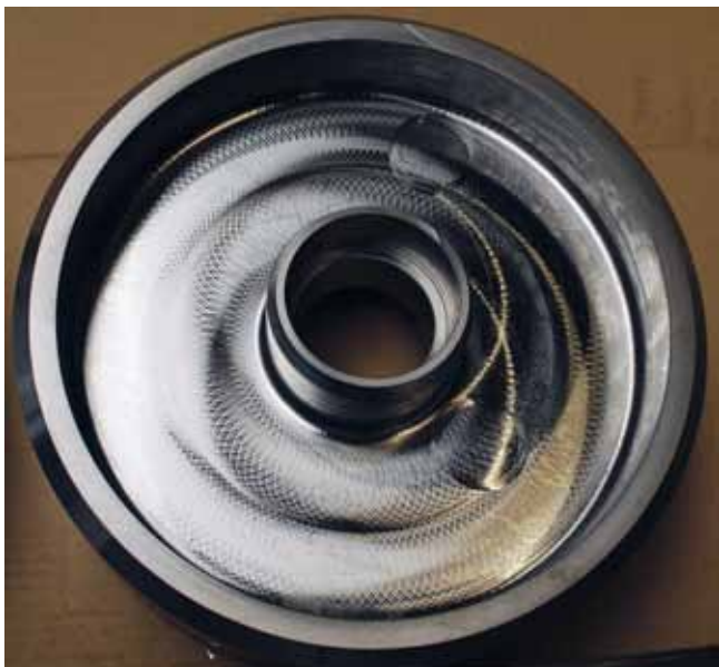
Räder für Schienenfahrzeuge: Bei SMW Metallverarbeitung werden solche Bauteile nicht mehr gedreht, sondern gefräst.
