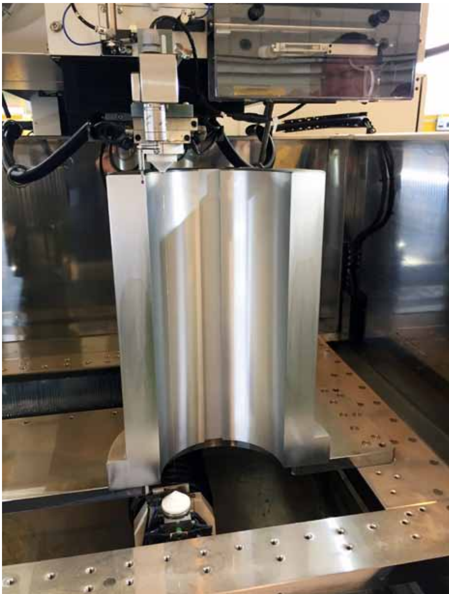
Die neue Funktionalität 3D-Touch Probe beinhaltet neben einem beweglichen Taster auch eine 3D-Funktion. Nach dem Tasten eines Werkstückes werden die Achsen im Raum der Aufspannsituation gerecht verändert – somit reduzieren sich mannintensive Rüstzeiten.
