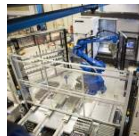
Die vollautomatisierte Fertigungszelle bei Sandvik Coromant in Gimo: Eine spezielle Software vernetzt die Okuma MULTUS U3000 mit dem Roboter, einem externen Werkzeugmagazin und dem Produktionsplanungssystem von Sandvik Coromant.
