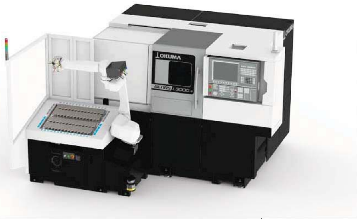
Die 1-Sattel-Drehmaschine GENOS L3000 mit der kompakten Automatisierungslösung Turn-Assist 200 von RoboJob ist für das unbemannte Be- und Entladen kleiner und mittlerer Losgrößen optimal geeignet.
